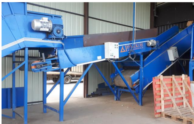
Слика 4.5.2-4. Коси тракasti транспортер и сепаратор за издвајање компоненти из отпада
