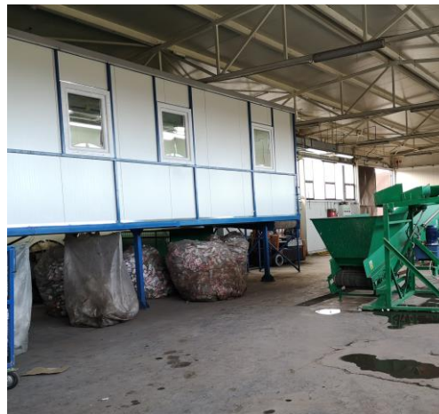
Слика 4.5.2-6. Сортирна линија са кабином контејнерског типа и траком за сортирање.
