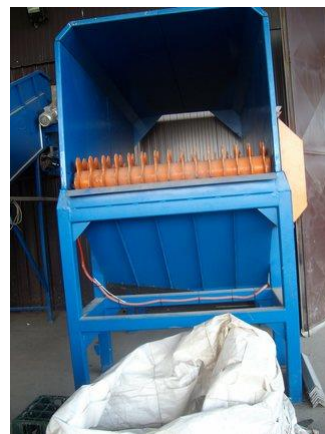
Слика 4.5.2-4. Коси тракasti транспортер и сепаратор за издвајање компоненти из отпада
