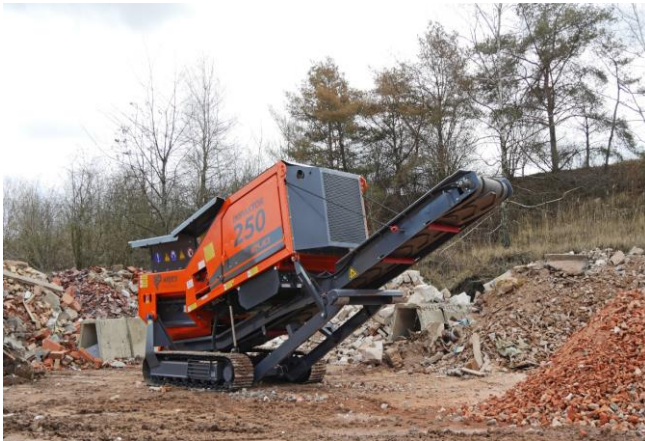
Слика 14.6-3. Машина/постројење за третман отпада од рушења и грађења (дробилица, магнетни сепаратор - слика лево и сито на крају конвејера (слика десно)
