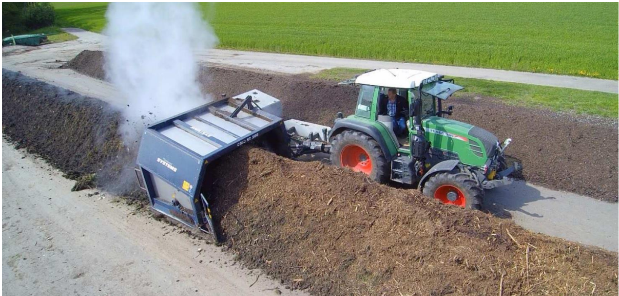
Слика 14.5.1-2. Трактор превртач у раду
