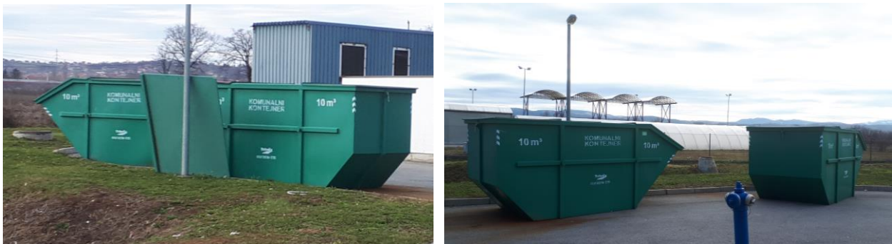
Слика 14.2-1. Комунални контејнери, затворен запремине 10 m 3
