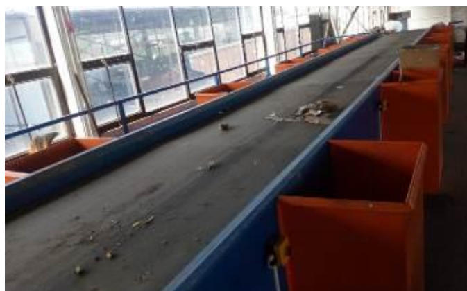
Слика 4.5.2-5. Платформа са траком за сортирање
