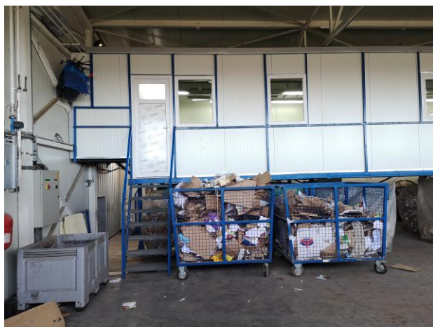
Слика 4.5.2-6. Сортирна линија са кабином контејнерског типа и траком за сортирање.
