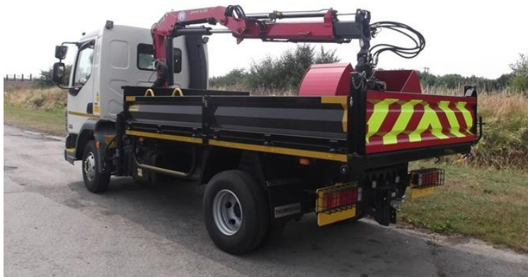
Slika 5.6 Primer kamiona za sakupljanje zelenog otpada iz parkova i sa javnih površina
