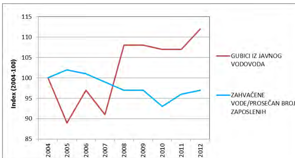
Слика 108. Индикатори ефикасности ресурса - Јавни водоводни системи у Србији [4]Извор података: Агенција за привредне регистре и Републички завод за статистику
