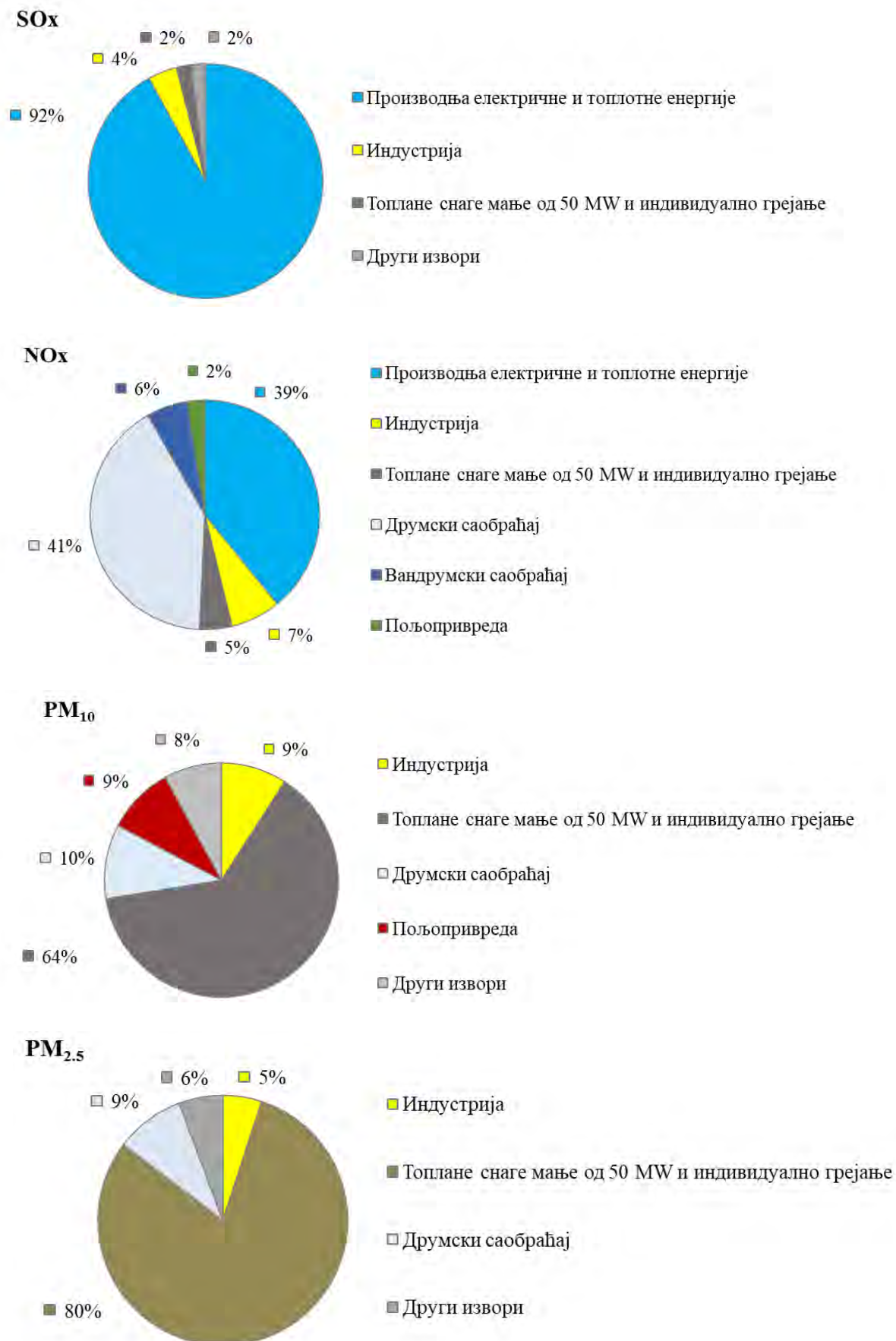
Слика 4. Допринос различитих сектора укупним емисијама оксида сумпора, азотних оксида, суспендованих честица PM_{10} и PM_{2.5} у Републици Србији у 2021. години
