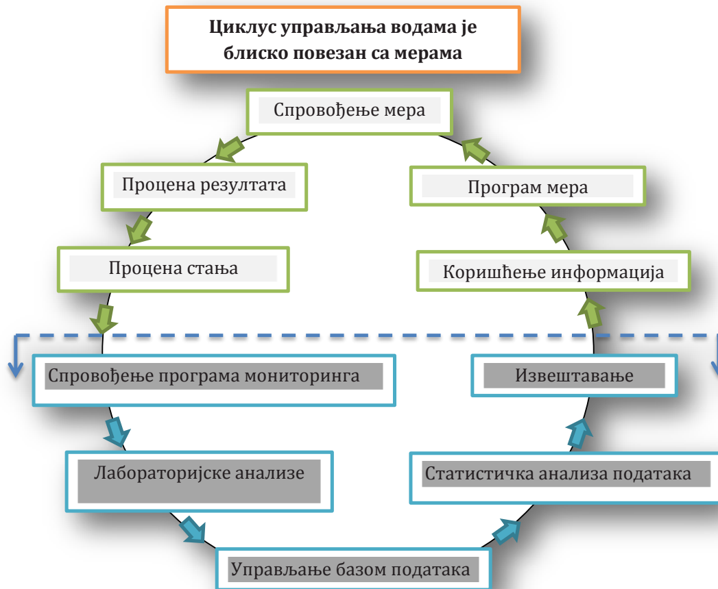
Слика 2.3. Мониторинг статуса вода у оквиру система управљања водама (доњи део дијаграма)
