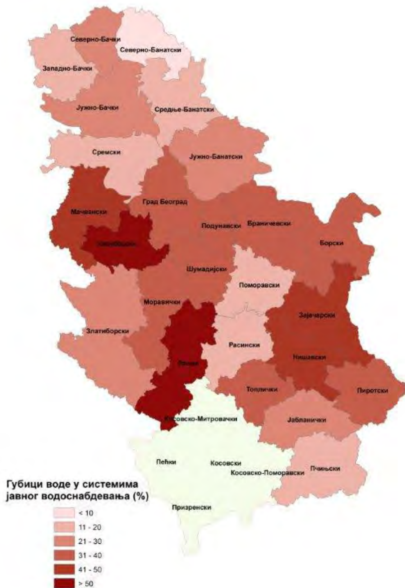
Слика 18. Губици воде у системима јавног водоснабдевања на нивоу округа/области Две области Рашка и Колубарска се истичу са губицима већим од 50% јер су у њиховим општинским водоводним системима у Новом Пазару 72% и Лајковцу 66% екстремни губици. Веома високе губитке имају поједини системи и то на пример: Бајина Башта 64% и Бојник чак 82%, иако њихове области (Златиборска и Јабланичка) припадају зони губитака 21-30%. (Слика 18) Посебно је значајан податак о величини губитака из београдског водоводног система који износи око 30%, чијим би се смањењем за 10% годишње обезбедила количина воде еквивалентна потребама снабдевања града Крагујевца.
