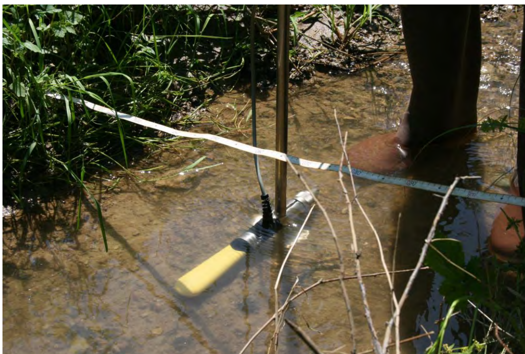
Фотографија 3. Мерење протока воде на малом експерименталном сливу, помоћу електромагнетног хидрометријског крила Ott Nautilus, водоток Милановац (Беомужевић)
