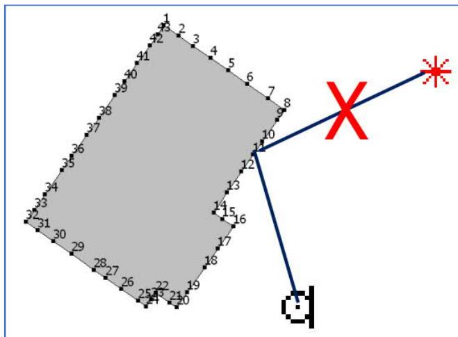
**SLIKA 8.1:** Prekomerni detalji na poligonu zgrade ne dovode do refleksija
